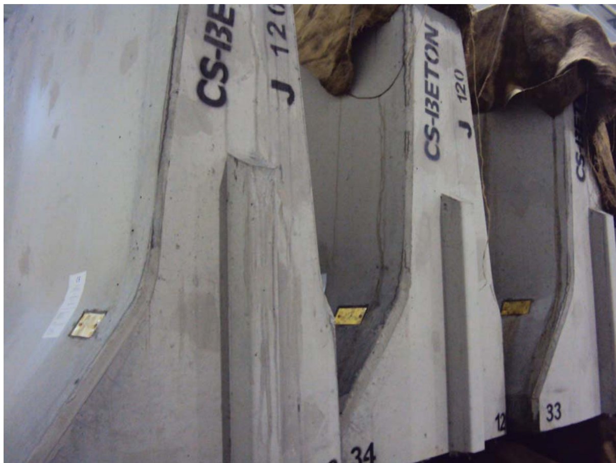
Obrázek 14 – Značení barvou na jednom čele každého dílce
