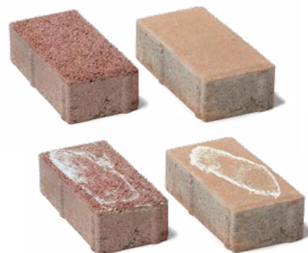
Ukázka povrchu a povrchu s cimento-vápněným výkvětem.
