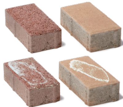
Ukázka povrchu a povrchu s cemento-vápenným výkvětem.
