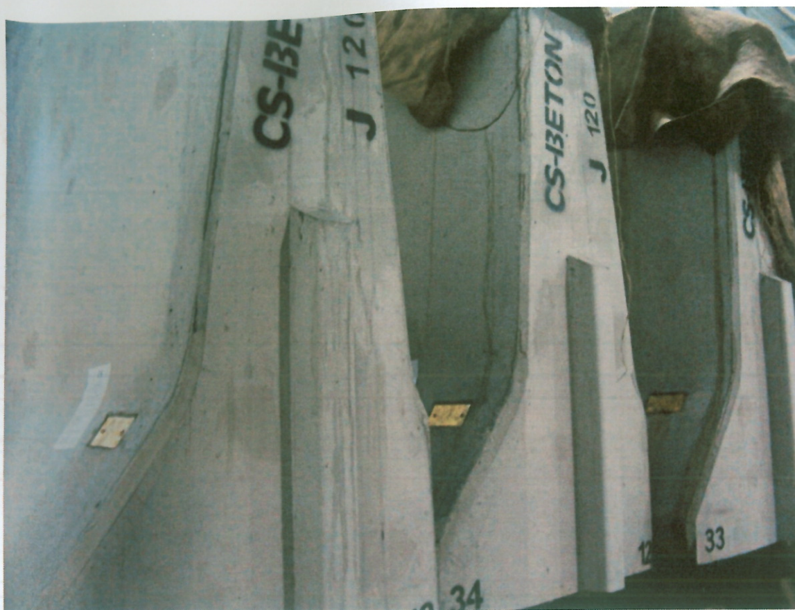
Obrázek 15 – Značení barvou na jednom čele každého dílce
