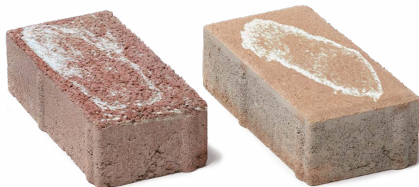
Dlažba s výkvětem
