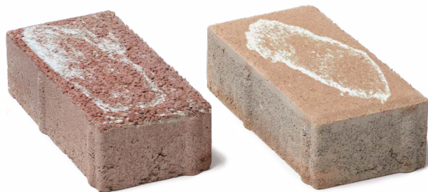
Dlažba s výkvětem
