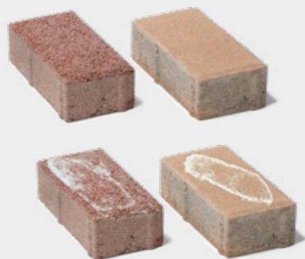
Ukázka povrchu bez a ukázka s cimento-vápenným výkvětem.
