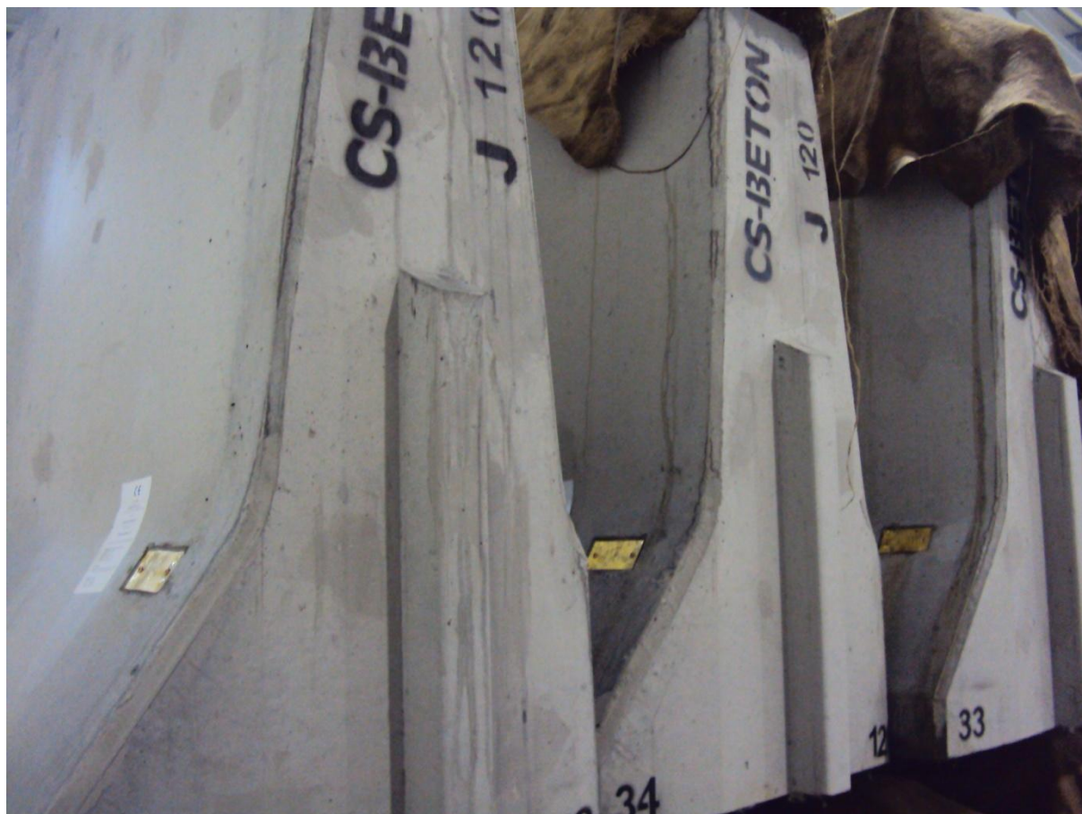
15. ábra – Festéssel való jelölés minden elem egyik homlokrészén
