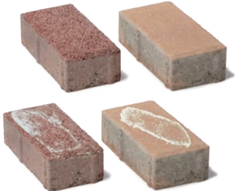
Ukázka povrchu bez a ukázka s cemento-vápenným výkvětem.
