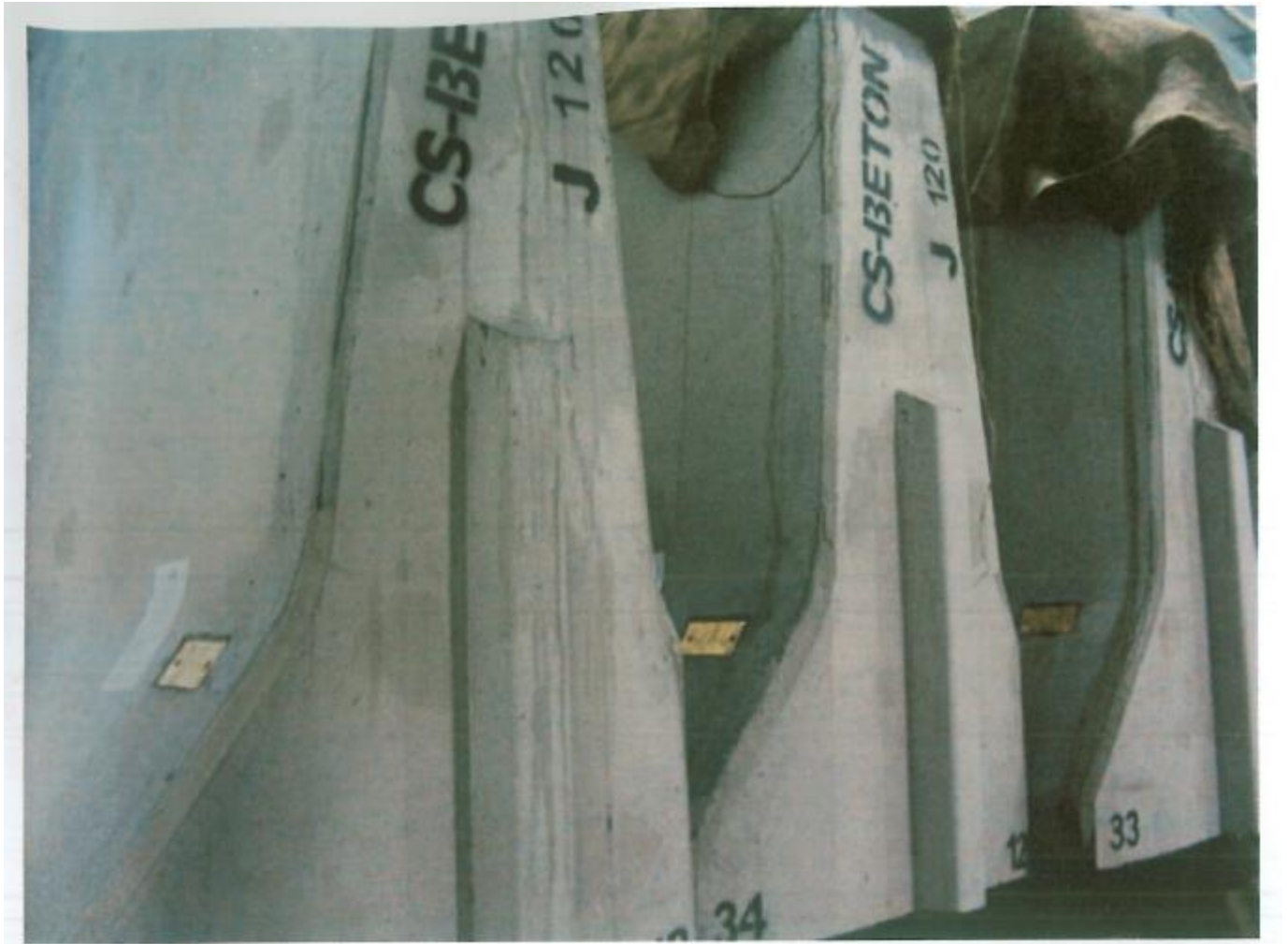
Abbildung 15 – Farbmarkierung auf einer Seite jedes Teils
