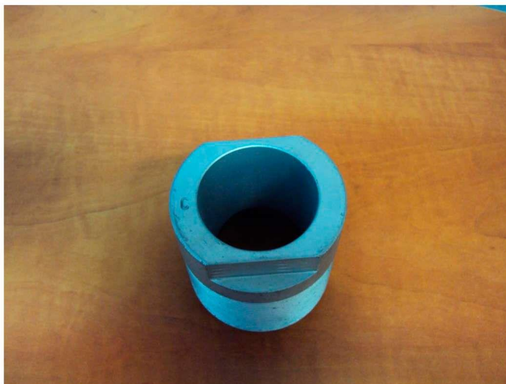
Rysunek 14 – Oznakowanie części elementu łączącego
