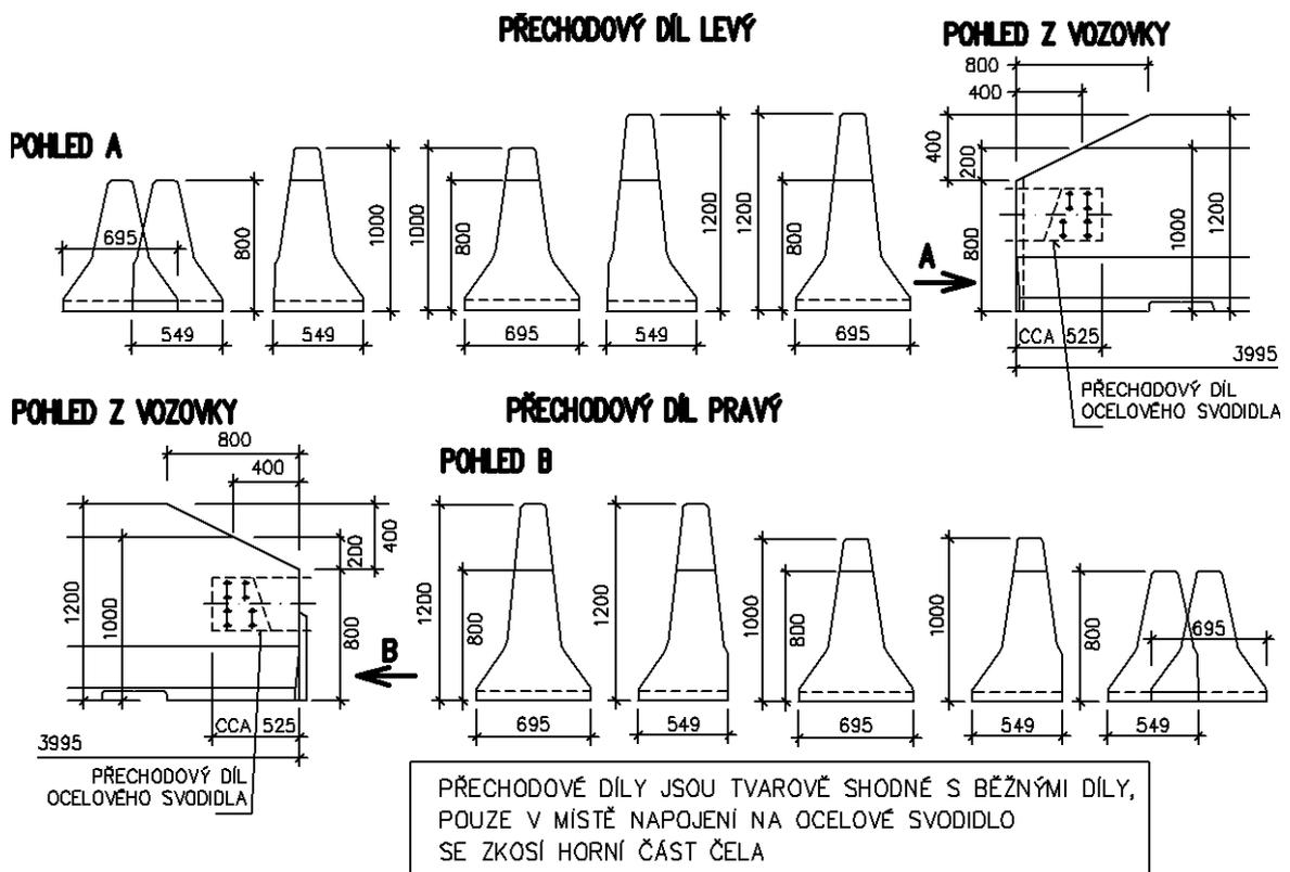
**Obrázek 9 – Přechodové díly na ocelové svodidlo**
