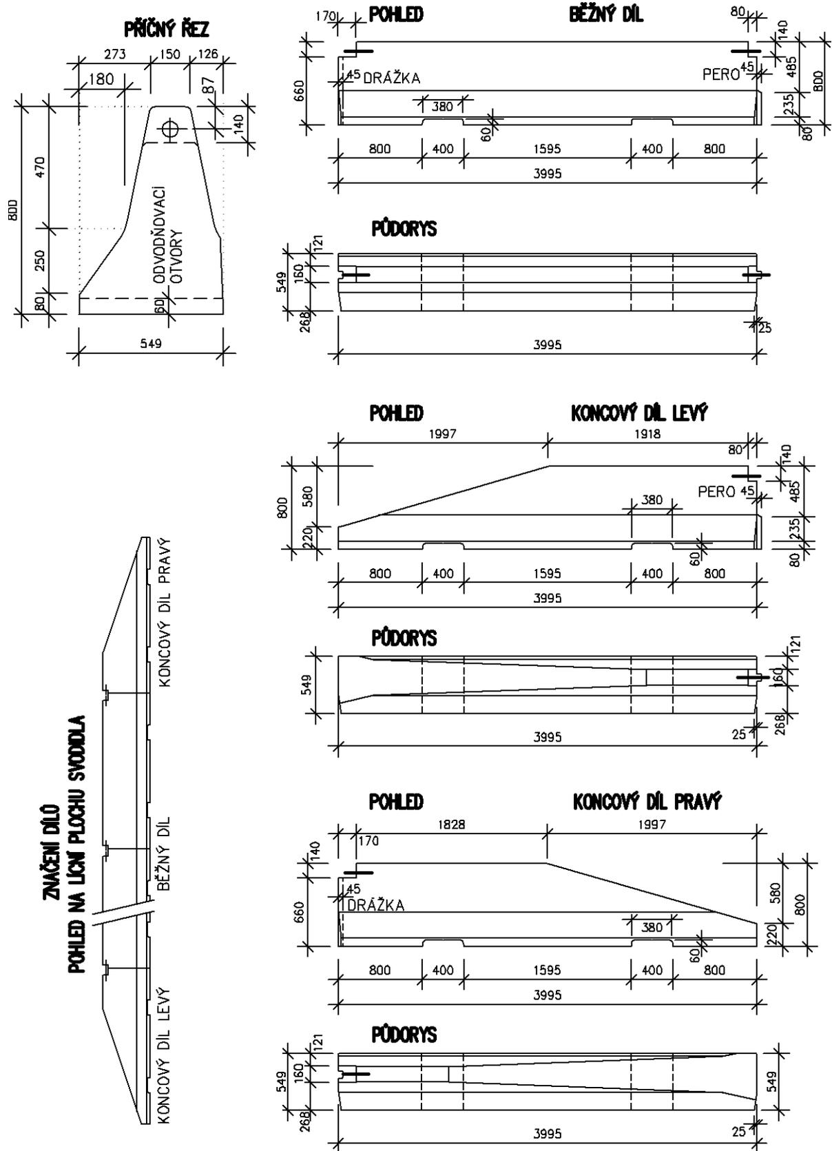
Obrázek 2 – Jednostranné betonové svodidlo výšky 0,8 m – běžný a koncový díl
