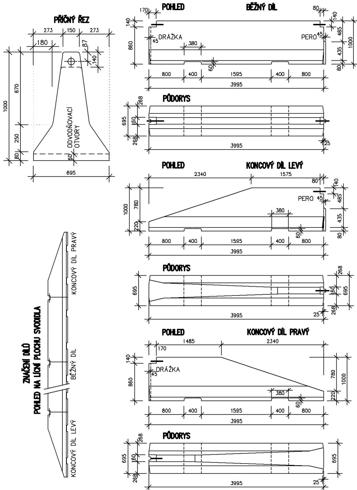
Obrázek 5 – Oboustranné betonové svodidlo výšky 1 m – běžný a koncový díl
