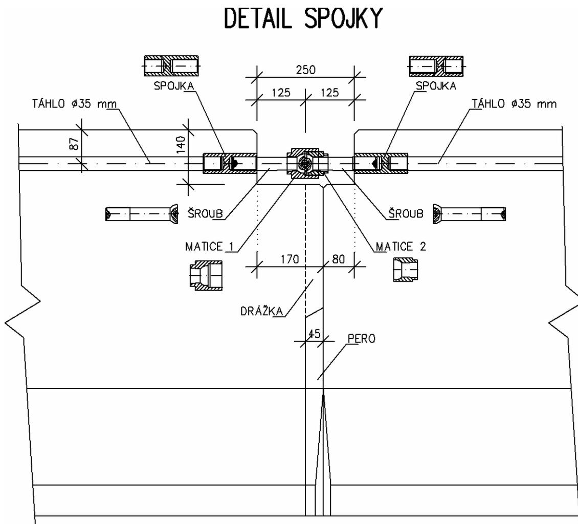
Obrázek 1 – Zámek svodidel - spojka
