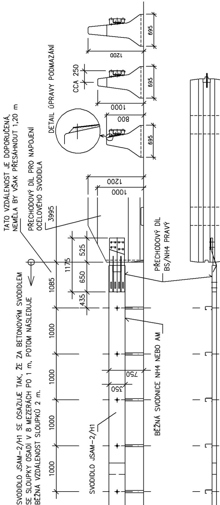
**Obrázek 11 – Příklad napojení ocelového svodidla JSAM-2/H1**
