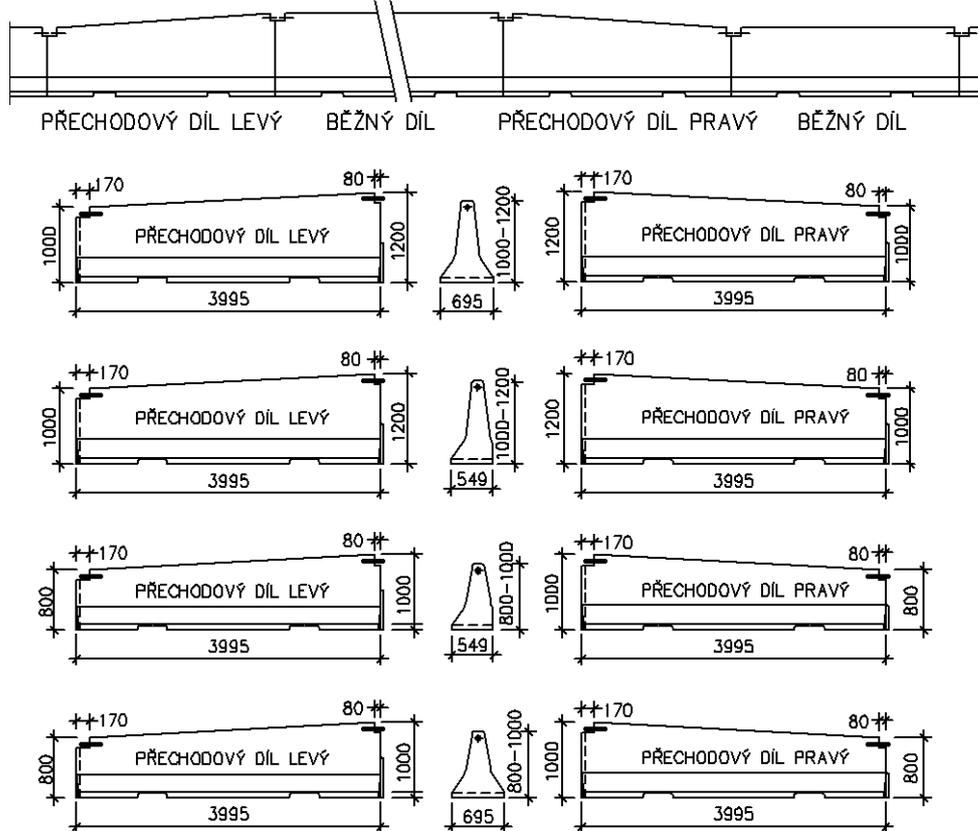
**Obrázek 8 – Výškový přechod mezi svodidly CS BETON**
