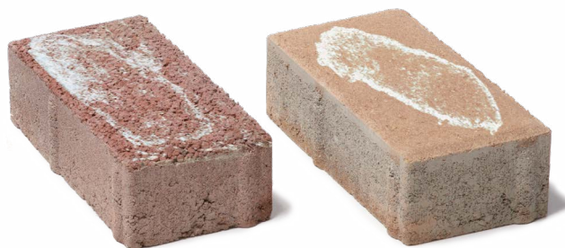
Dlažba s výkvětem
