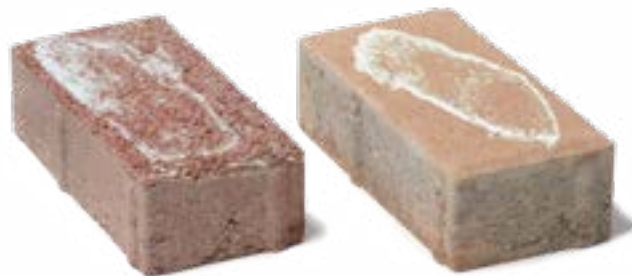
Dlažba s výkvětem
