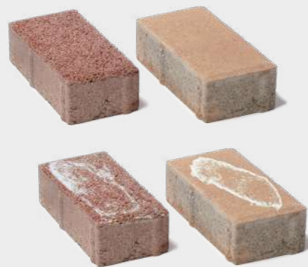
Ukázka povrchu bez a ukázka s cimento-vápeným výkvvětem.
