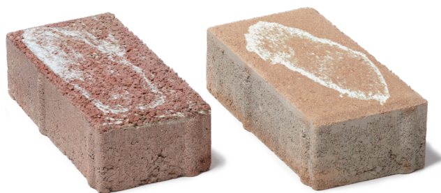
Dlažba s výkvětem
